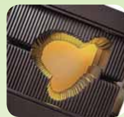
図2. X線の出口に装備されている、細かい絞り装置
