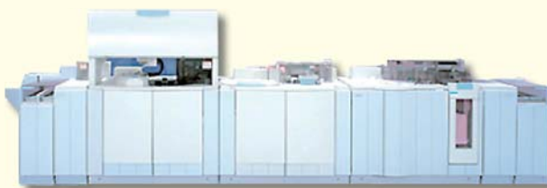
コレステロールや中性脂肪など約40種類（40項目）の検査に使用している日立生化学自動分析装置
